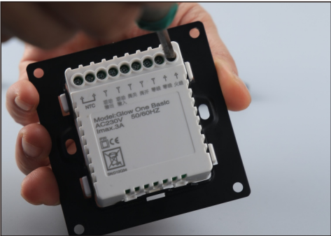
按接线图，接到接线端子上，用螺丝拧紧
