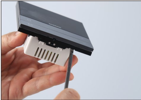
拆开主控板： 用3.5mm 宽的一字改锥沿斜 面伸到卡槽
