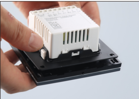
将 LCD 板和电源板角度对准连接在一起
