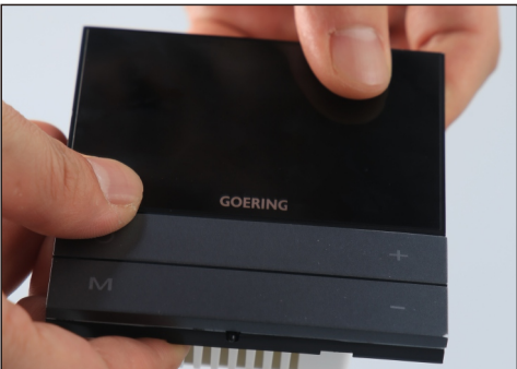
先成 30 度角用力按下侧， 卡住上壳，听到清脆的响声，安装完毕
